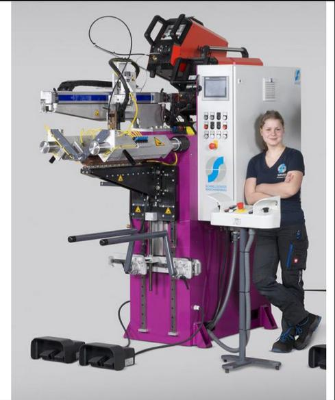
El objeto de esta máquina es poder realizar soldaduras en esquinas, de altísima calidad sin operaciones posteriores, preparaciones de máquina muy rápidas, con utillajes sencillos y genéricos. Sin operarios cualificados se dificulta el proceso de soldadura y por este motivo aumentan las consultas en soldadura robotizada, que acompañadas por un plegado de calidad, permiten una continuidad en la calidad de la pieza final. . Una solución intermedia que garantiza soldaduras perfectas
